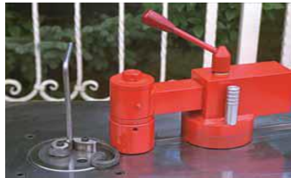
شكل رقم (10) ماكينة وقوالب الحنى الآلي المستخدمة في تشكيل الوحدات الحلزونية ellsenwroughtironmachinery.com/wrought-iron-scroll-ben
