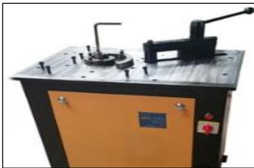
شكل رقم (10) ماكينة وقوالب الحنى الآلي المستخدمة في تشكيل الوحدات الحلزونية ellsenwroughtironmachinery.com/wrought-iron-scroll-ben
