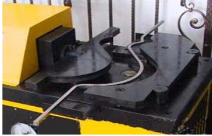
شكل رقم (9) ماكينة وقالب تشكيل وحدات الحديد المعماري بالحني الآلي Joachim Krieger – Wrought iron machine systems Germany www. wrought-iron-systems.com
